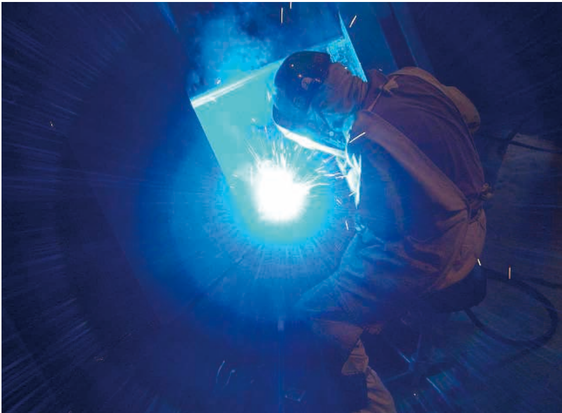
气体保护电弧焊 (GMAW) — 二氧化碳气体保护电弧焊示例一
